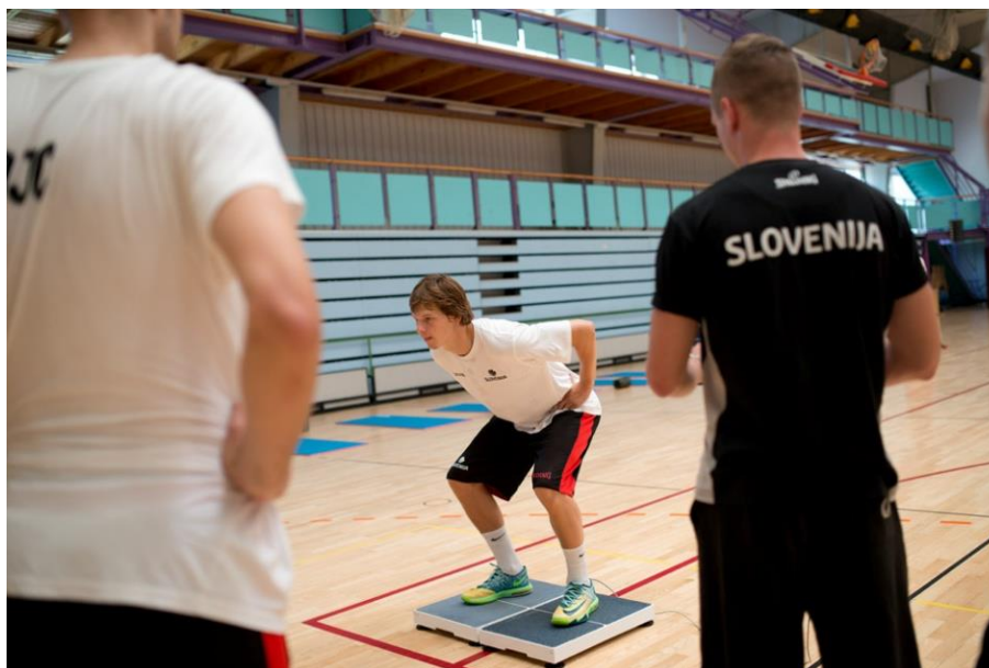
Slika 6: Merjenje vertikalnega skoka s pomočjo terenske pritiskovne plošče (foto: Miha Matavž).
